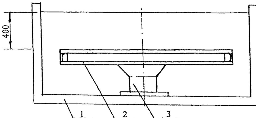
1 — емкость с водой; 2 — образец стеклопакета; 3 — вакуумная присоска
