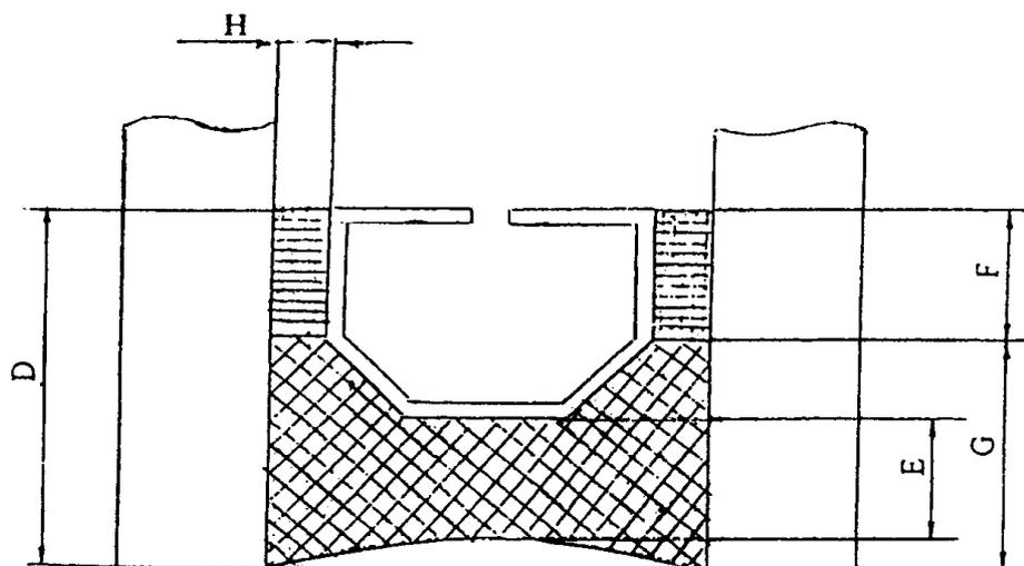
*D* — общая глубина герметизирующего слоя; *F* — глубина первого герметизирующего слоя; *G* — глубина второго герметизирующего слоя; *E* — глубина наружного герметизирующего слоя; *H* — толщина первого герметизирующего слоя
