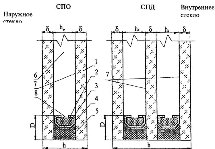
1 — стекло; 2 — дистанционная рамка; 3 — влагопоглотитель; 4 — нетвердеющий герметик; 5 — отверждающийся герметик; 6 — воздушная прослойка (межстекольное расстояние); 7 — рекомендуемые варианты расположения низкоэмиссионного покрытия в случае его применения; 8 — дегидрационные отверстия;  $\delta$  — толщина стекла;  $h$  — толщина стеклопакета;  $h_c$  — расстояние между стеклами;  $D$  — глубина герметизирующего слоя
